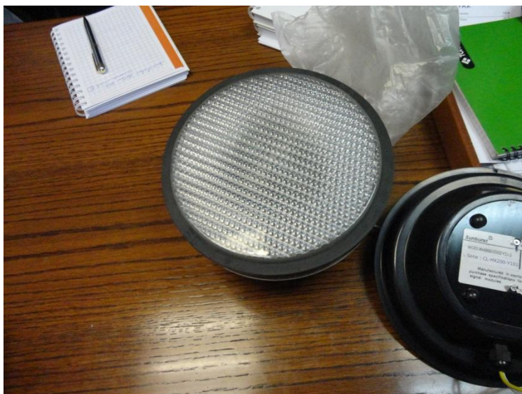
Foto 10 – Foco aberto (quatro LEDs na parte central)
