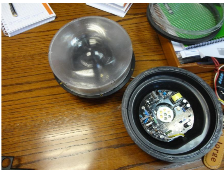
Foto 10 – Foco aberto (quatro LEDs na parte central)
